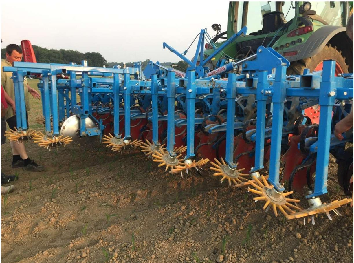
Le maïs a plus ou moins quatre feuilles et il est temps de le désherber. Pour cela il va d'abord passer à la bineuse pour éliminer les plantes adventices entre les lignes. Dans quelques jours il passera la houe rotative et la herse étrille pour également désherber dans la ligne. L'espacement entre les lignes est de 45 cm.
