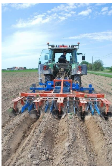
Démonstration de la bineuse-butteuse sur les parcelles de la variété robuste Zen à la Ferme de l'Abbaye de Boneffe.
