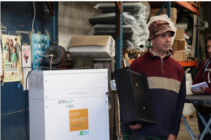
À l'intérieur du réfrigérateur, on peut percevoir une odeur d'éthylène, une molécule qui accélère le mûrissement des fruits. Pour contrer cet effet, Pierre Marie utilise une machine équipée de permanganate de potassium qui absorbe l'éthylène. Le ventilateur intégré aide à la circulation de l'air pour optimiser l'absorption. Cette machine est particulièrement nécessaire pour les fruits croquants et sucrés, mais elle n'est pas requise pour les variétés comme la Ducasse.
