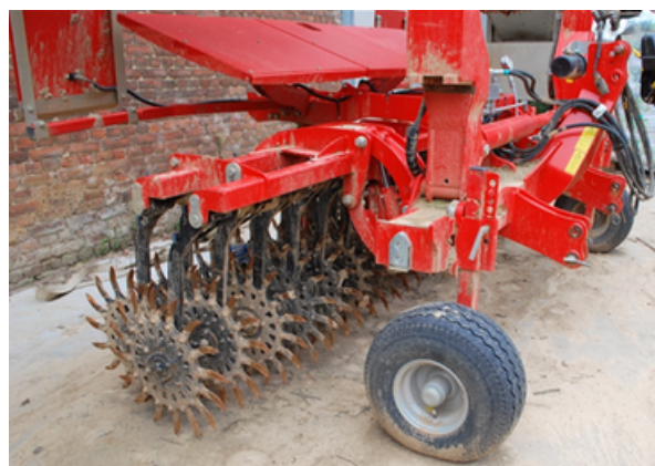
HOUE ROTATIVE UTILISÉE EN CULTURE DE CÉRÉALES, HARICOT ET PETIT POIS À LA FERME LE MAIRE
