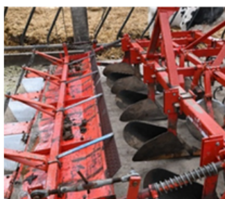
BINEUSE-BUTTEUSE À PATTES D'OIE UTILISÉE POUR LA DERNIÈRE INTERVENTION DE BUTTAGE
