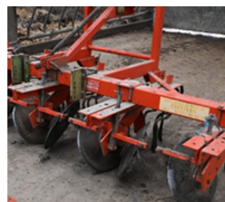
BINEUSE-BUTTEUSE À PATTES D'OIE UTILISÉE POUR LA DERNIÈRE INTERVENTION DE BUTTAGE
