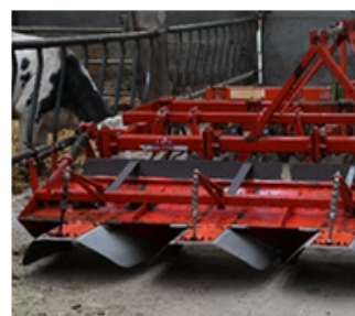
BINEUSE-BUTTEUSE À PATTES D'OIE UTILISÉE POUR LA DERNIÈRE INTERVENTION DE BUTTAGE
