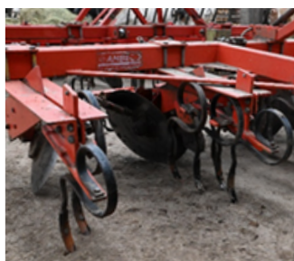
BINEUSE-BUTTEUSE À PATTES D'OIE UTILISÉE POUR LA DERNIÈRE INTERVENTION DE BUTTAGE
