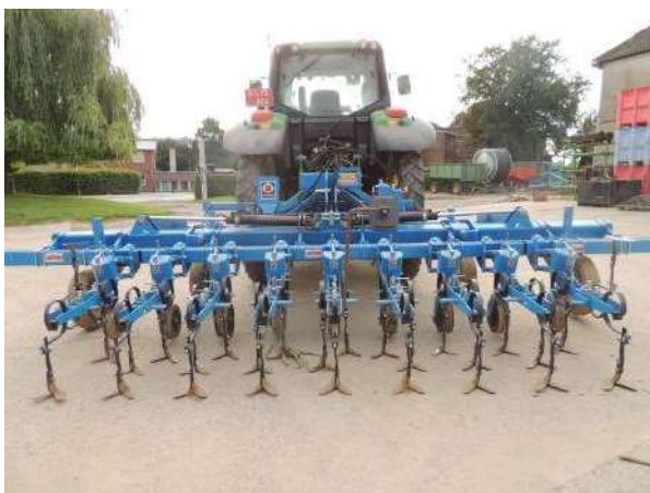
Bineuse guidée par caméra.
