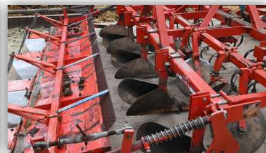
Butteuse utilisée à partir du troisième buttage. La machine est composée de pattes d'oie suivies de plus grands disques de buttage. S'en suivent des capots permettant d'éviter que la terre ne recouvre les plants de pomme de terre. La machine se termine par des capes de buttage trapézoïdales qui compressent et façonnent les buttes.
