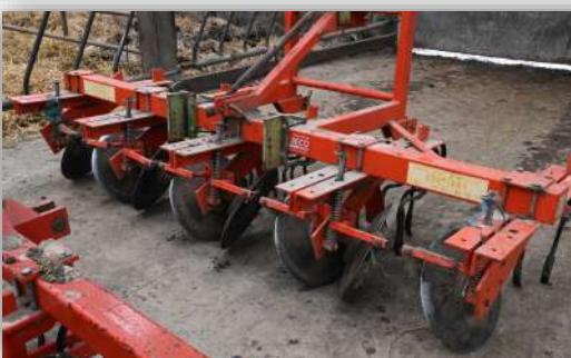
Butteuse à petits disques utilisée pour les premiers et deuxièmes buttages, en combinaison avec la sarclieuse à socs. La machine est composée de pattes d'oie à l'avant (socs de la sarclieuse) qui raclent le sol en surface et éliminent ainsi les adventices. La terre grattée est ameublie, ce qui facilite par la suite le façonnage des buttes par les petits disques de la butteuse.
