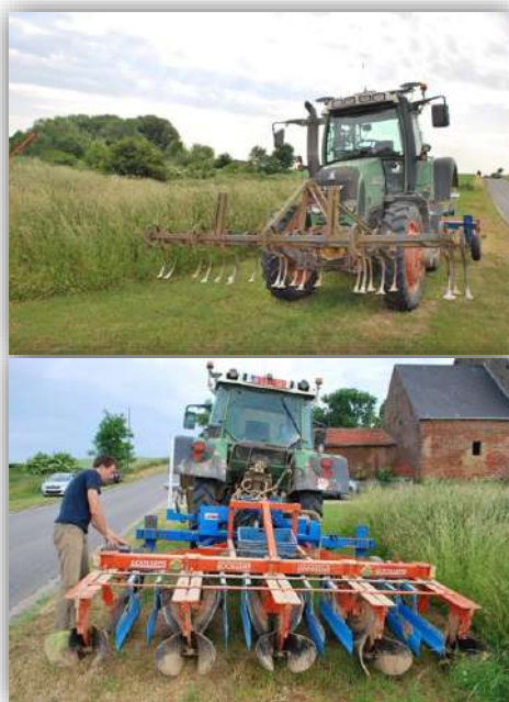
La butteuse-sarceleuse que Cédric utilise pour contrer les adventices et garantir la bonne croissance des tubercules en cultures de pomme de terre. La première photo illustre l'avant de la machine avec la sarceleuse; la deuxième photo montre l'arrière de la machine avec la butteuse.
