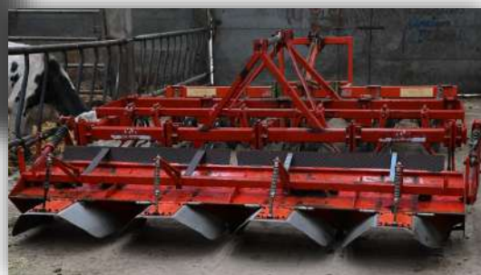
Butteuse utilisée à partir du troisième buttage. La machine est composée de pattes d'oie suivies de plus grands disques de buttage. S'en suivent des capots permettant d'éviter que la terre ne recouvre les plants de pomme de terre. La machine se termine par des capes de buttage trapézoïdales qui compressent et façonnent les buttes.
